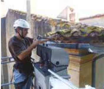
Inspection d'interstice avec un fibroscope (caméra endoscopique).
