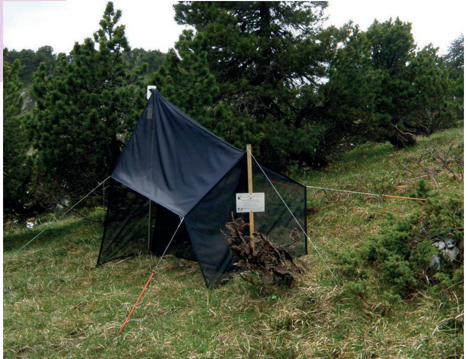
Illustration 6 : tente Malaise posée avec piquets et fils de tension
