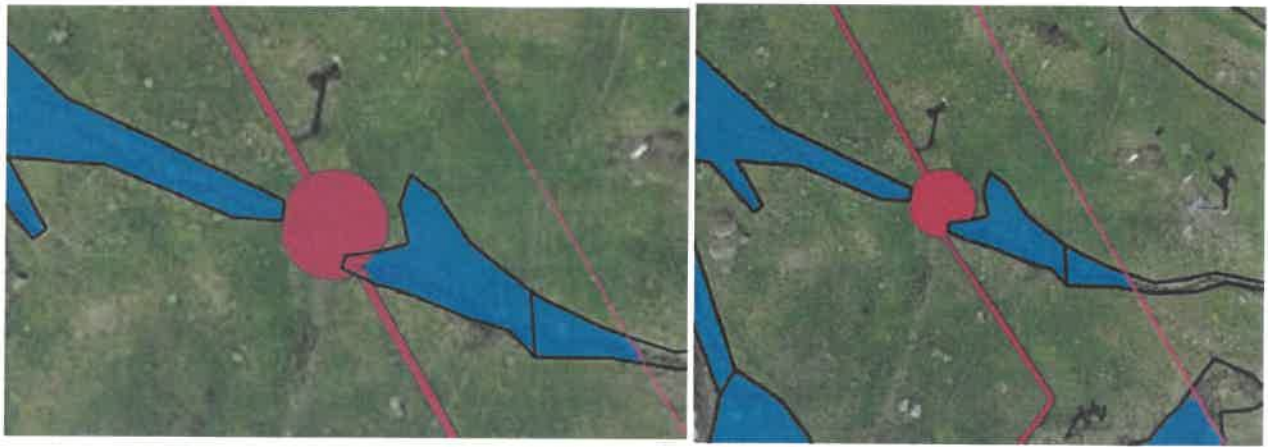
Limitation de l'emprise de terrassement autour du P5 KARUM secteur d'évitement visé par la mesure ME3 « Modification de l'emprise de terrassement au niveau des pylônes et du passage de la pelle araignée »
